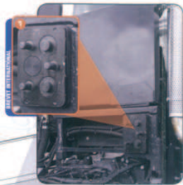
Placa de cuplare rămâne fixă pe vehicul și se conectează cu ansamblul caroseriei. Ele pot gestiona până la 3 conexiuni hidrolice simultan și automat.
